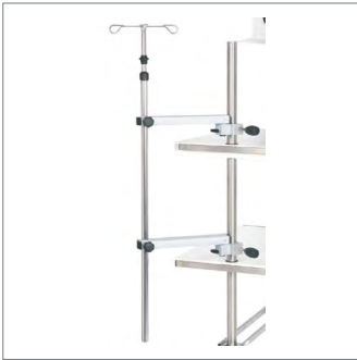
Tige porte perfusion télescopique, 4 crochets sur bras de déport 300 mm. Charge max : ensemble 32 kg, et 2 kg / crochet
